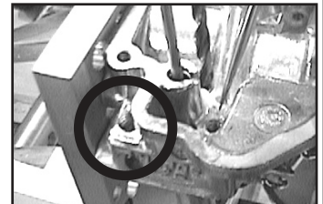
Remove bowl vent passage plug.
